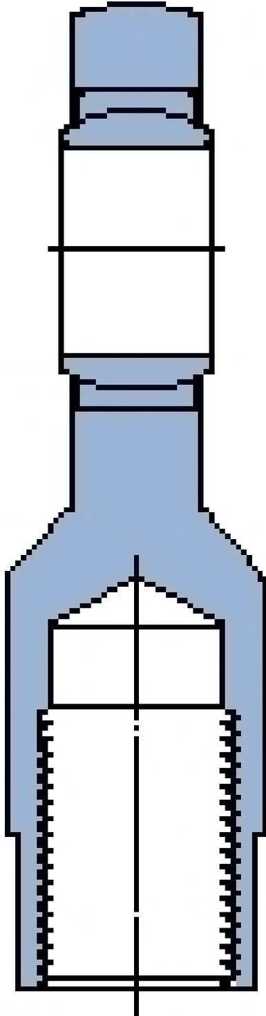
**SIL 6 E - Gelenkkopf mit Innengewinde Stahl/Stahl**
