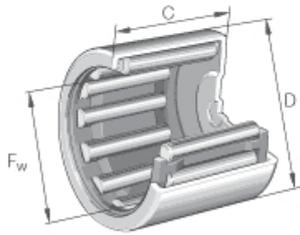
**Douille à aiguilles avec fond BK1614-RS-L271**
